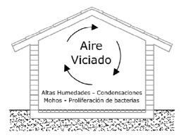
En una construcción levantada a base de cemento convencional, las paredes actúan como barrera al vapor de agua que evita que el edificio transpire y favorecen la creación de un clima de malestar pudiendo ser causa de varias enfermedades.
